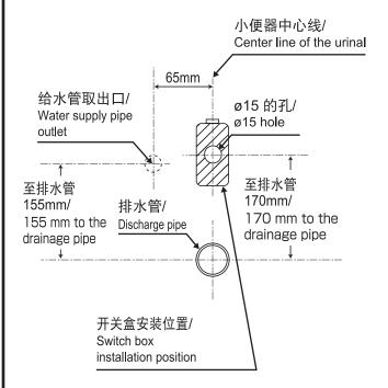
※请在装饰板上开一个ø15的孔,再将电源线引入室内。/
