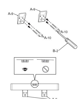
此时,如果小便器(A-1)没有达到规定高度,可拧松后背吊钩(A-9)的木螺钉(A-10),在与墙壁之间塞入金属片进行调整。/
