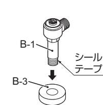
※ストレート管と床にすき間がある場合、防カビ性のシリコーン系シール材(メジシール)にて充てんしてからカバー(B-3)を取り付けてください。
