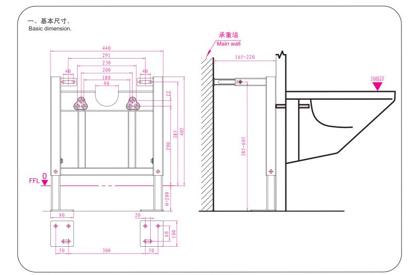
二、把支架靠墙放置在安装位置上,适当旋松螺栓,调整地 脚滑动管长短至所需高度,用水平仪保持支架水平,调整好 后锁紧螺栓。
