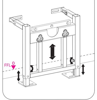
三、设定好支架到墙面的距离,适当旋松螺栓,调整墙脚滑动管至所需长度,并用水平仪保持支架垂直,最后旋紧螺 栓
