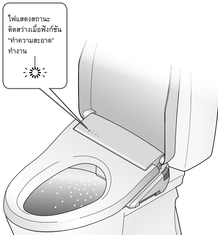
ระบบการทำความสะอาดตัวเองอัตโนมัติ (ดูรายละเอียดที่หน้า 20 และ 21)
